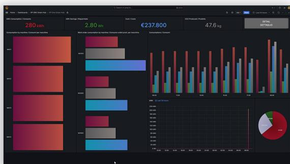
Il sistema permette di intercettare e monitorare **tutti i consumi** della macchina come motori, pompe e aria compressa.
