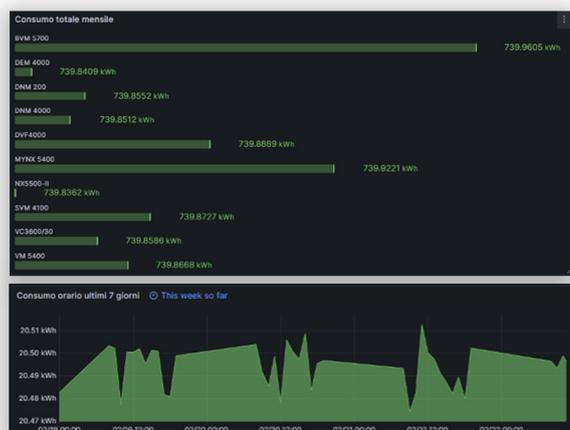
Il sistema permette di intercettare e monitorare **tutti i consumi** della macchina come motori, pompe e aria compressa.
